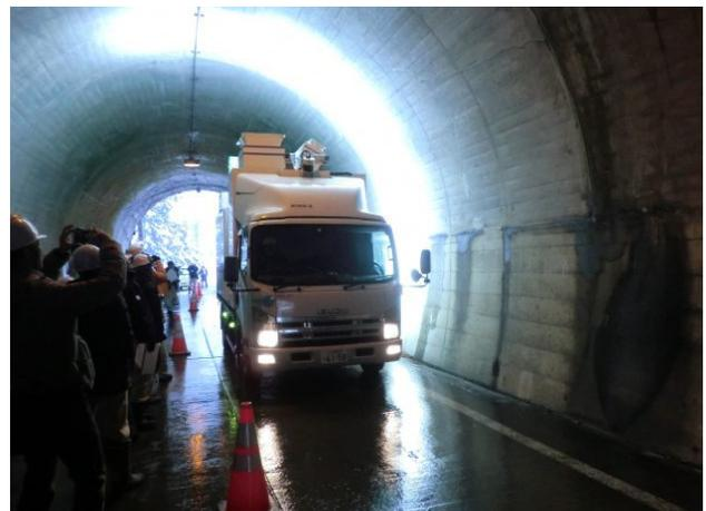
図-6 トンネル用計測車両の例
